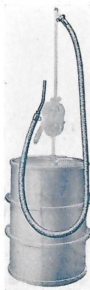
Fig. 7. — Distribution de carburants, lubrifiants, etc. : postes mobiles.
